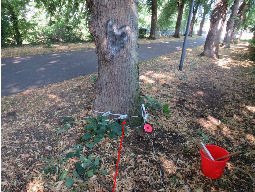
Abbildung 10: Sensoren am Stammfuß/Wurzelanläufe.
