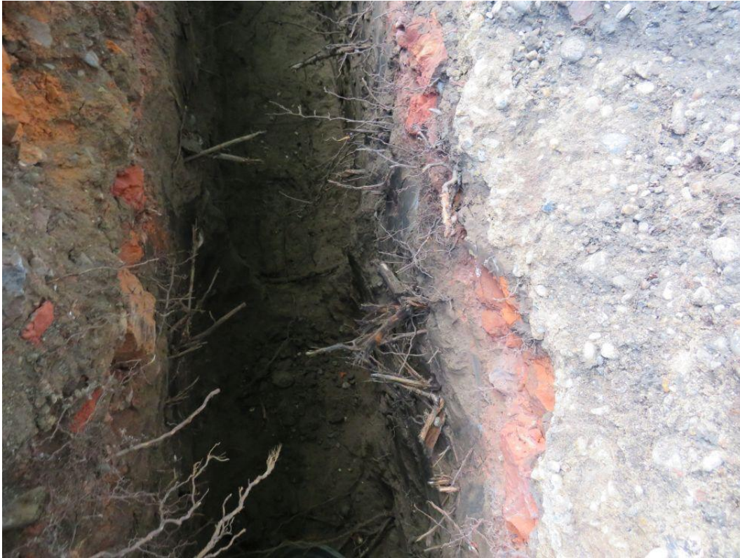
Abbildung 24: Westlicher Teil des Grabens, angrenzend der Beetfläche, sind in den oberen 0,50 m des Suchgrabens, Wurzeln der angrenzenden Sträucher vorhanden, die bereits überwiegend abgestorben sind.
