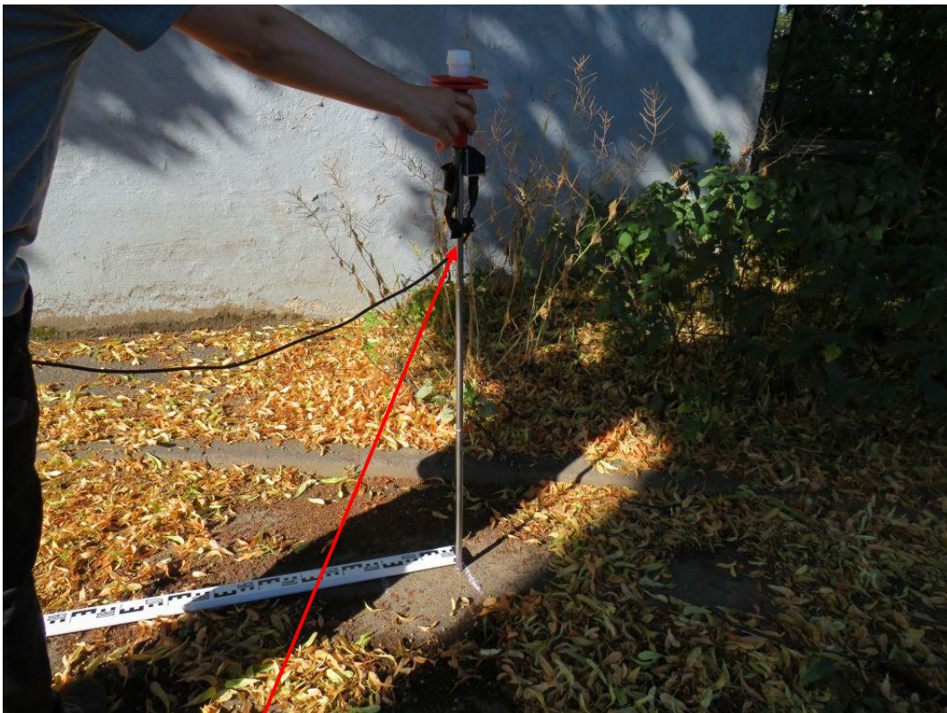
Abbildung 11: Sensor-Lanze zum Sondieren des Wurzelraums.
