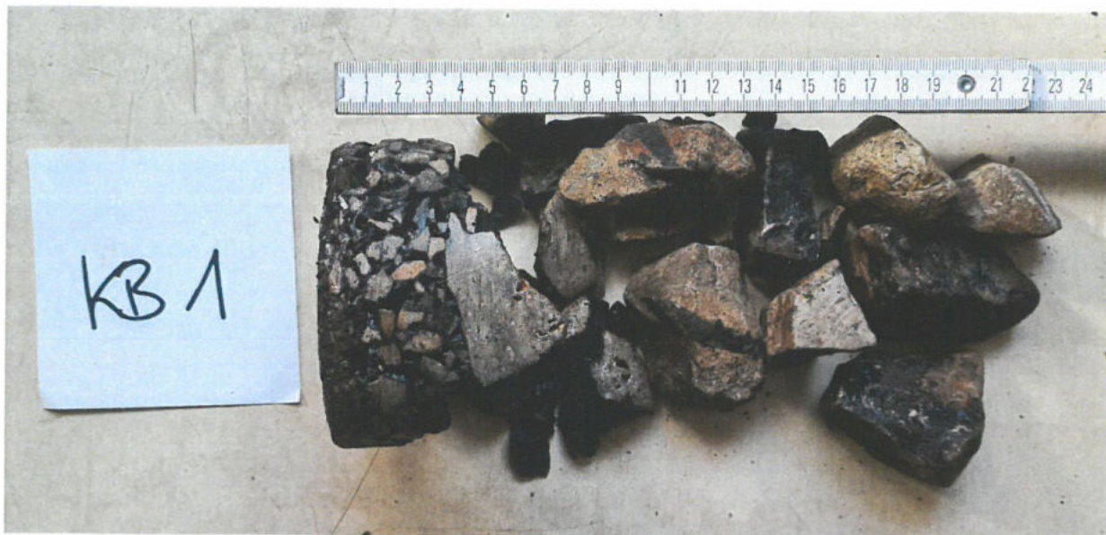
Bild 1: Bohrkern der KB 1 mit Schottertragschicht vom 21.10.2022
