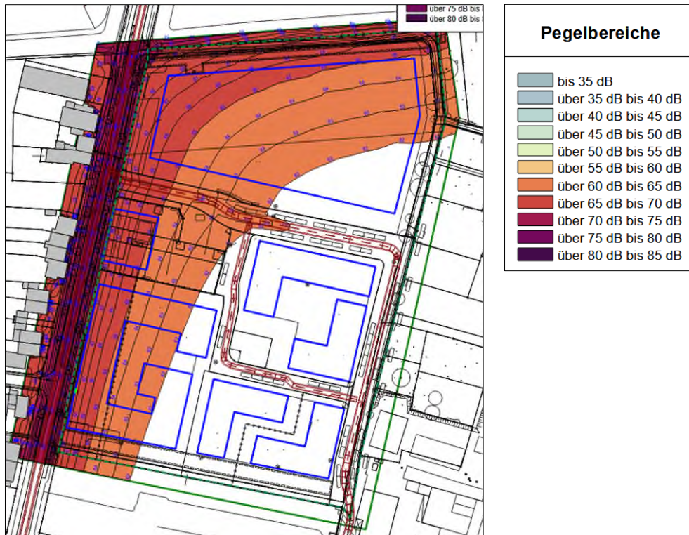
Abbildung 12: Beurteilungspegel der Verkehrsgeräusche, Bereich mit Beurteilungspegeln >62 dB(A), Zeitraum tags [Quelle: Schalltechnische Untersuchung zum vorhabenbezogenen Bebauungsplan VBP 14, ACCON Köln GmbH, März 2026]
