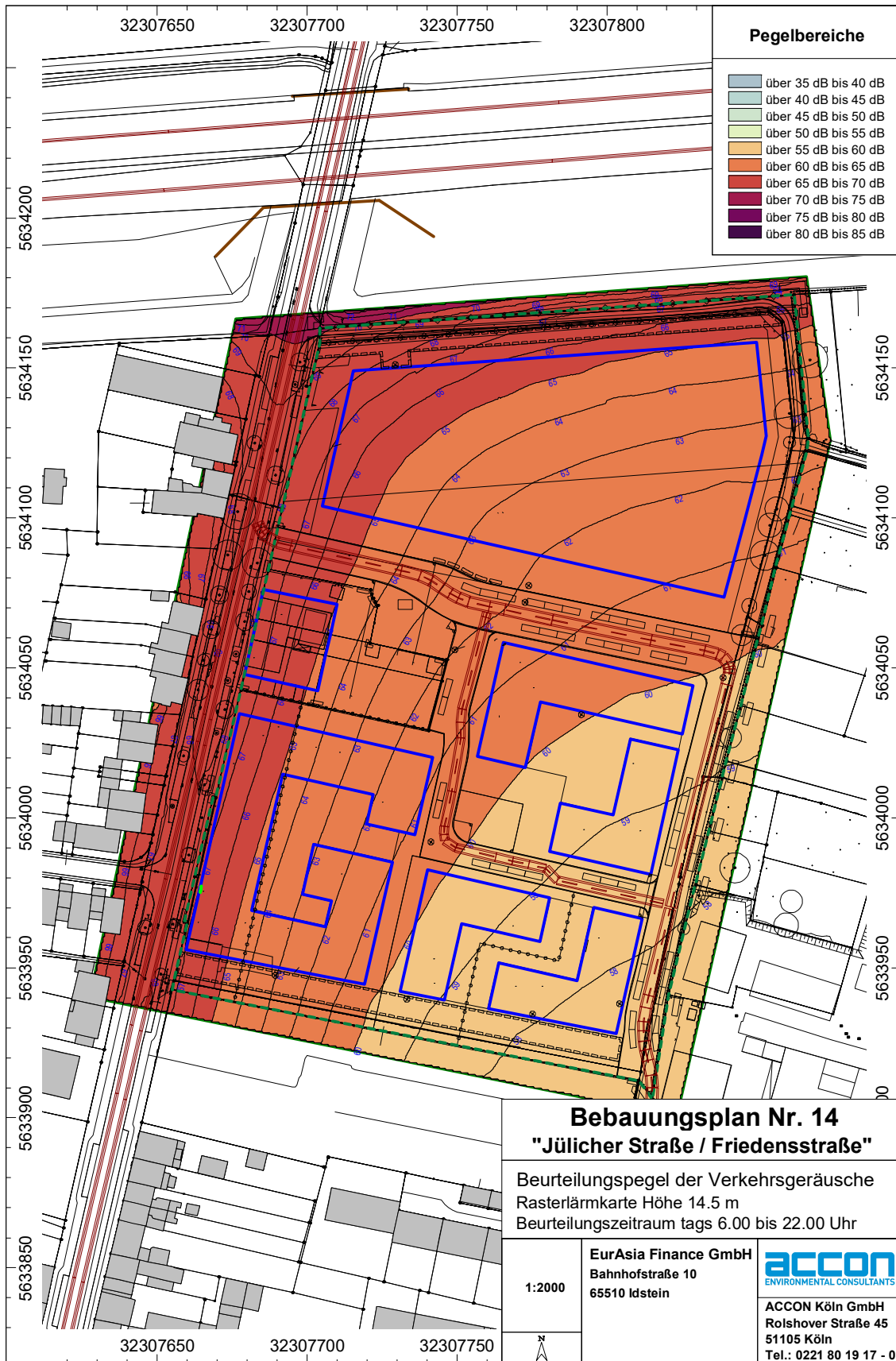
Abb. 3.4.5 Darstellung der Verkehrsgeräuschsituation innerhalb des Plangebiets tags - Lärmkarte für eine freie Schallausbreitung (4.OG)
