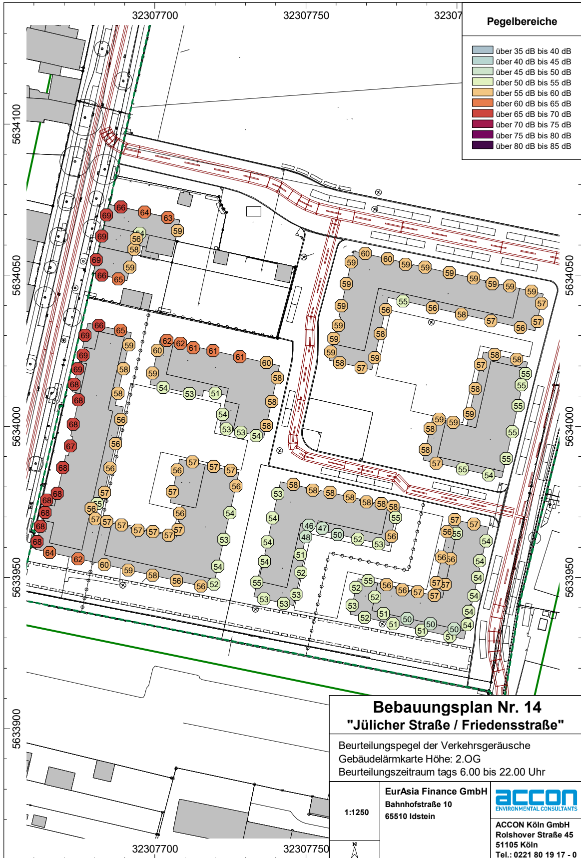
Abb. 3.4.14 Darstellung der Verkehrsgeschwindigkeitssituation innerhalb des vorhabenbezogenen Teil des Plangebiets tags - Gebäudelärmkarte (2.OG)
