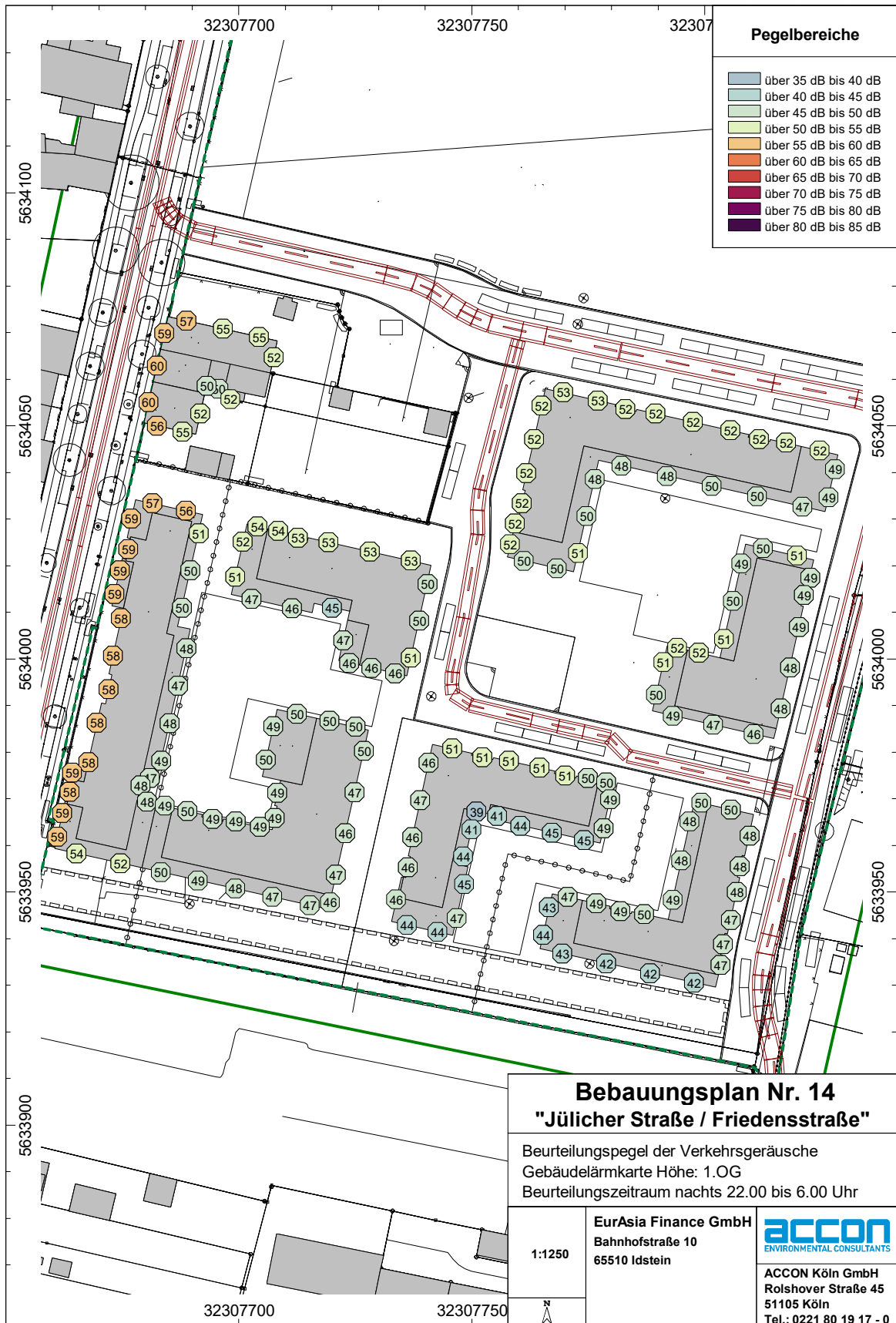
Abb. 3.4.18 Darstellung der Verkehrsräuschkarte innerhalb des vorhabenbezogenen Teil des Plangebiets nachts - Gebäudelärmkarte (1.OG)
