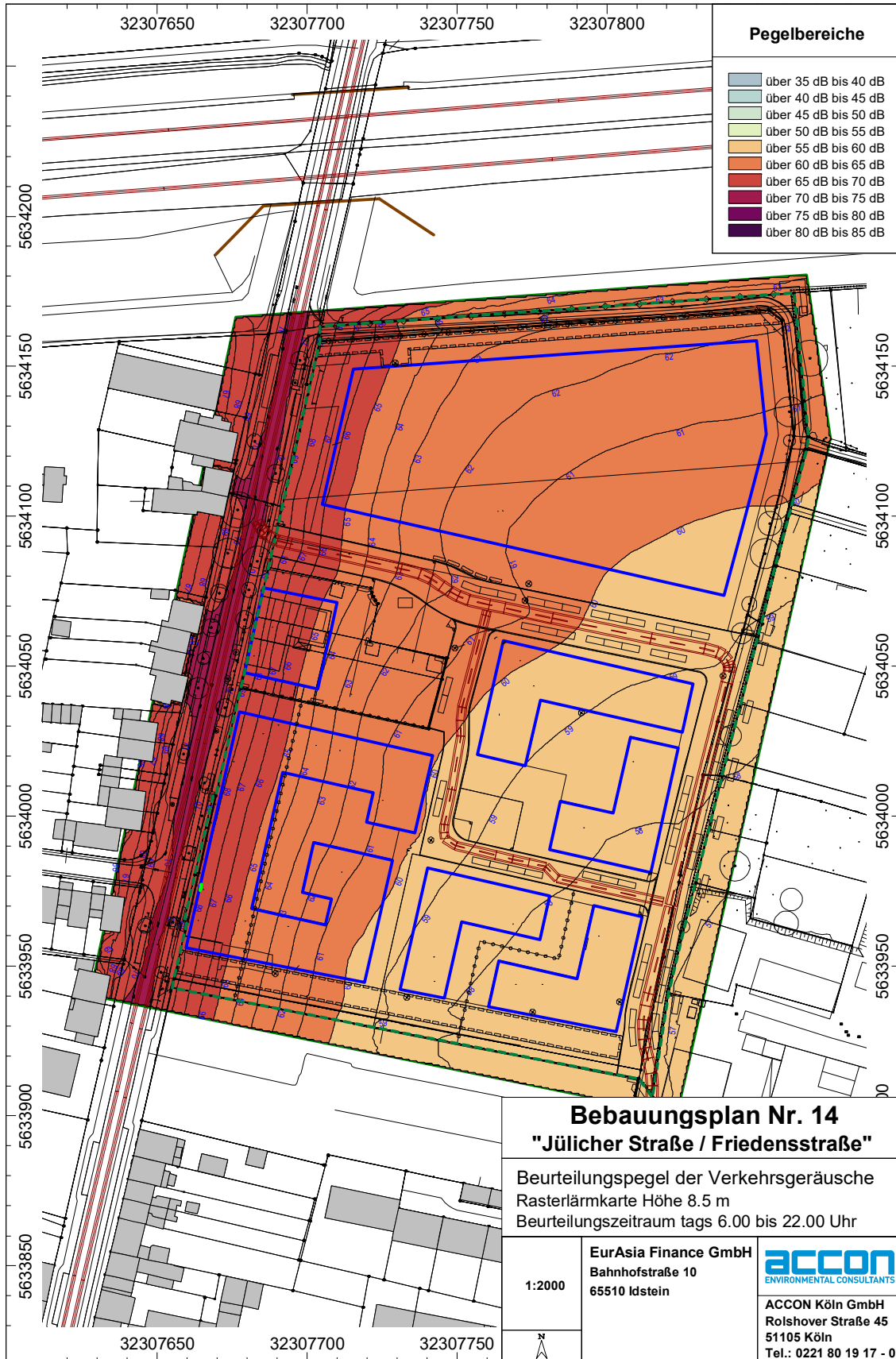
Abb. 3.4.3 Darstellung der Verkehrsgeräuschsituation innerhalb des Plangebiets tags - Lärmkarte für eine freie Schallausbreitung (2.OG)
