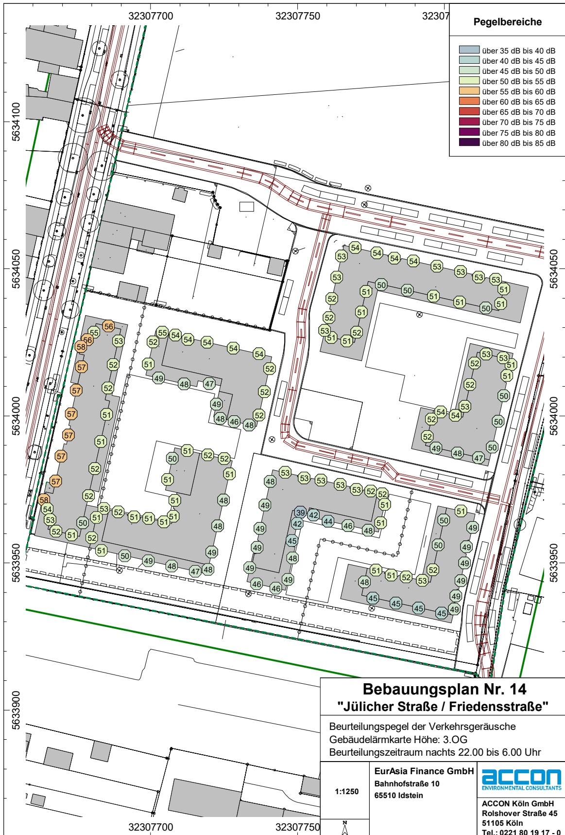
Abb. 3.4.20 Darstellung der Verkehrsgäruschsituation innerhalb des vorhabenbezogenen Teil des Plangebiets nachts - Gebäudelärmkarte (3.OG)
