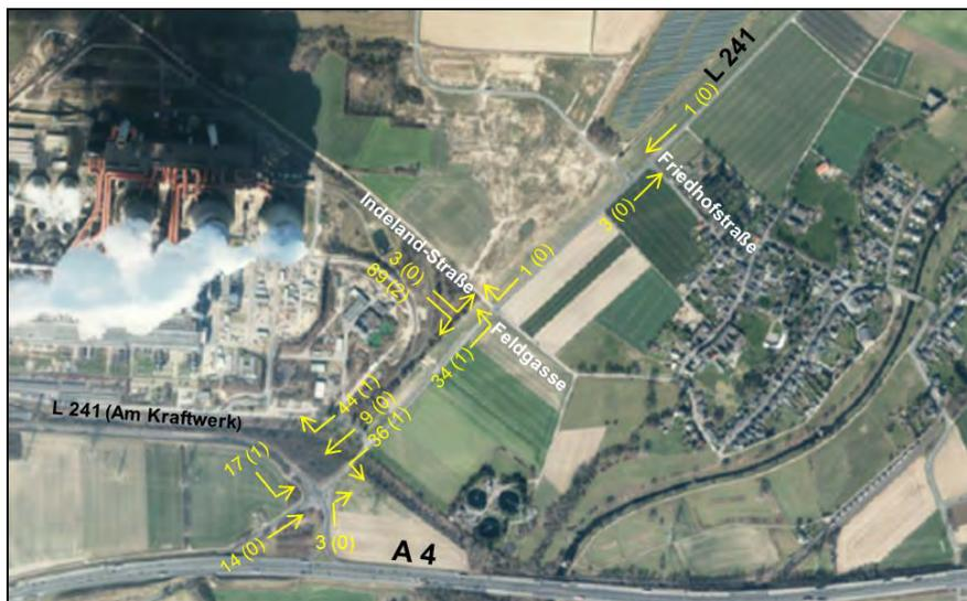
**Bild 30: Umlegung der zusätzlichen Kfz-Verkehre (Klammerwerte davon Lkw) für die nachmittägliche Spitzenstunde Prognose-Planfall 2**
