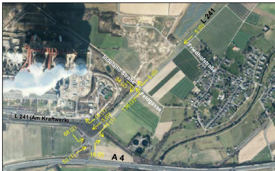
**Bild 23: Umlegung der zusätzlichen Kfz-Verkehre (Klammerwerte davon Lkw) für die morgendliche Spitzenstunde im Prognose-Planfall 1**
