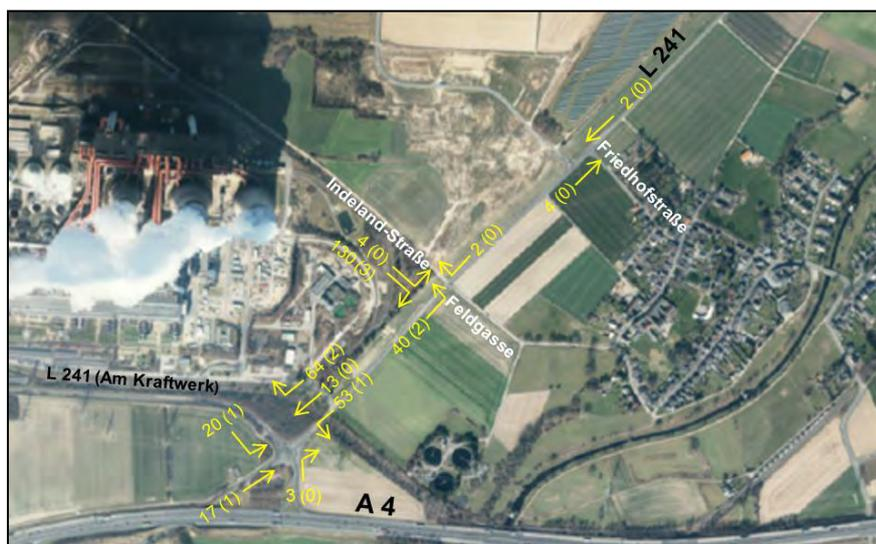
**Bild 24: Umlegung der zusätzlichen Kfz-Verkehre (Klammerwerte davon Lkw) für die nachmittägliche Spitzenstunde Prognose-Planfall 1**
